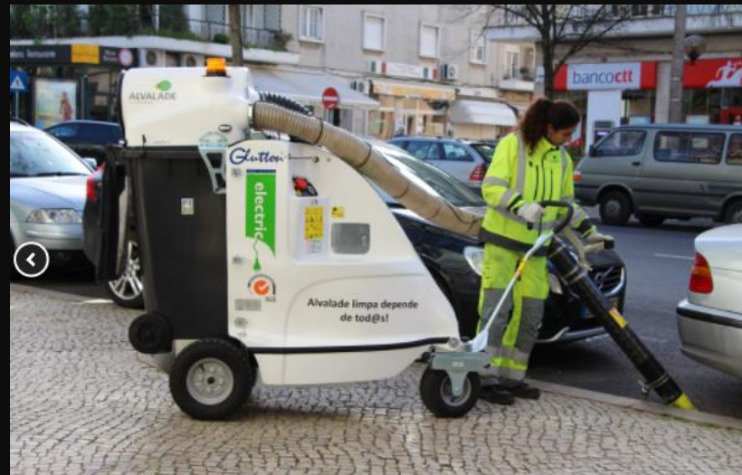
Fotografia – Varredura com aspirador
